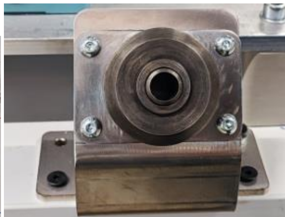
Rys. 5 – Widok przykładowych narzędzi do wywijania ekranu
