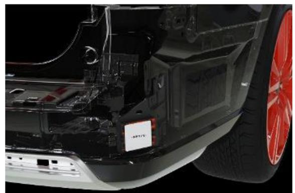
Figura 2. El radar se puede ubicar detrás de la carrocería exterior de un vehículo.
