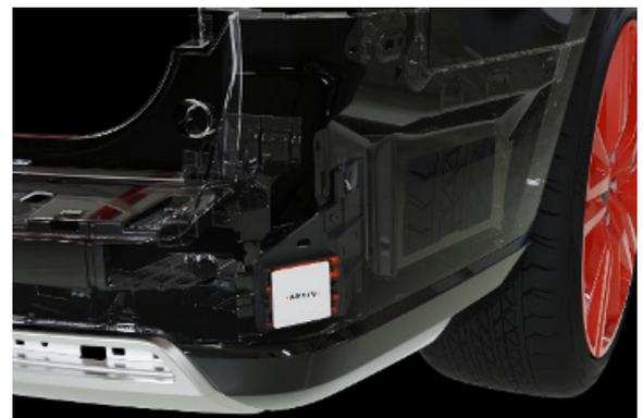
図2. レーダーは外装ボディの裏側に設置できます。
