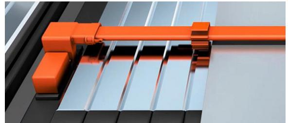
軽量化は、配線における重要な設計上の留意点ですが、スペースの制約も1つの要素です。成型されたバスバーは、丸いケーブルの1つの代替手段であり、パッケージング上のメリットをもたらします。自動的な組み立ても容易になり、品質と一貫性が向上します。Aptivは、バスバーの熱膨張とシールドの課題に対処するため、独自のインターフェース設計ソリューションを開発してきました。
