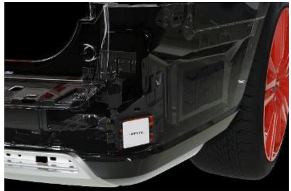
图 2. 雷达可被安装在汽车车身外壳后面
