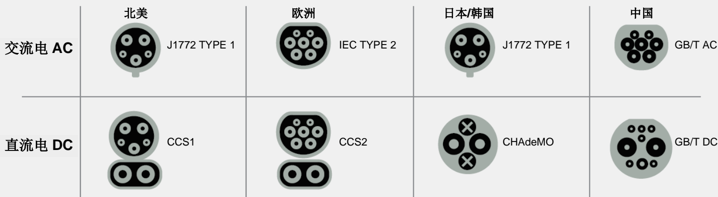
图 3：该图中的类型为车载连接器接口，因地区而异
