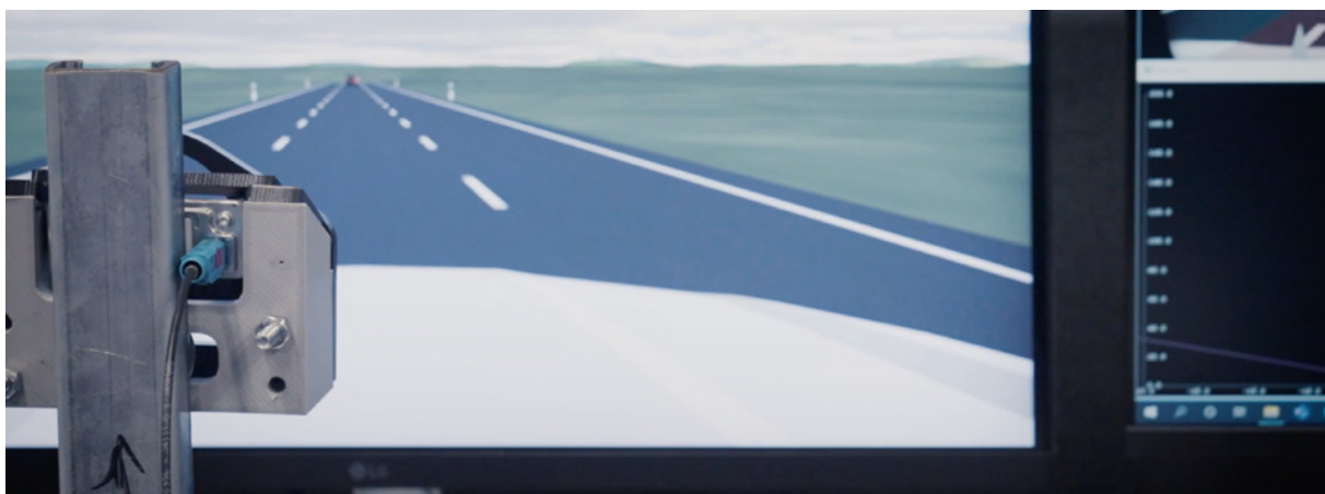
Hardware-in-the-loop: Un banco HIL presenta las entradas simuladas al hardware real.
